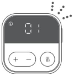
温熱オフ・EMSレベルを1～16に設定中にお肌が感知できない場合、レベル表示が点滅し約2分後に自動的に電源が切れます。お肌を軽く水で湿らせ、パッドをしっかり密着させてから再度お試しください。
