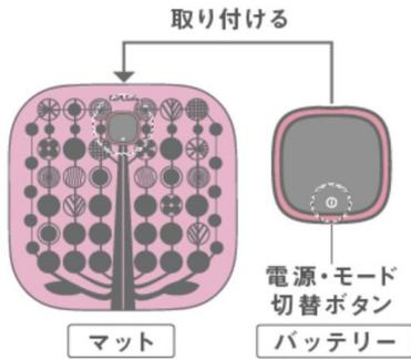
電源・モード切替ボタンを押すと、コントローラーから短いピープ音が2回鳴ると同時に、液晶画面に「1」と表示されます。
